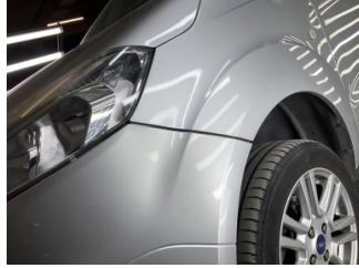
Tampon, ön, Ön tampon > Sabitlemesi Hatalı
