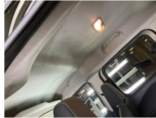
Döşemeler/Kapaklar, İç döşeme, arka > Deforme Olmuş
