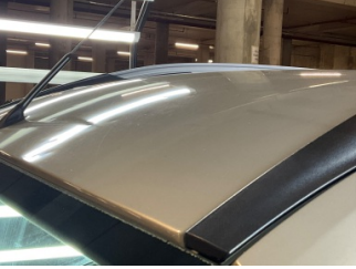
Tavan, Tavan > Dolu Hasarı
