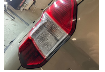
Arka lambalar, Arka lamba camı, sol > Çatlak
