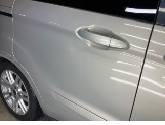
Kapı, sağ arka, Kapı, sağ arka > Ezik
