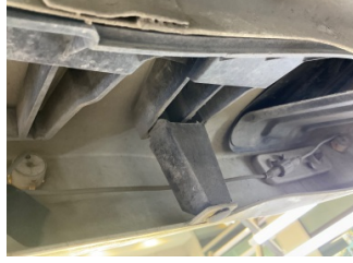
Tampon, arka, Bağlantı ayağı > Hasarlı
