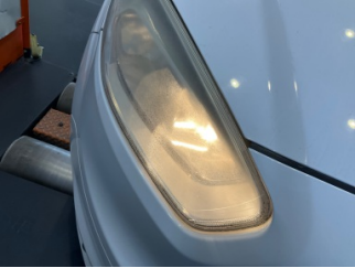
Farlar, Far camı, sağ > Deforme Olmuş
