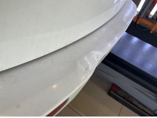
Tampon, arka, Arka tampon > Çatlak
