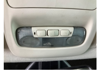
Elektrik donanımı/Pano, İç aydınlatma, ön > Ampülü Yanmıyor
