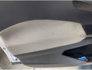
Döşemeler/Kapaklar, Kapı döşemesi, sol ön > Yanık Deliği
