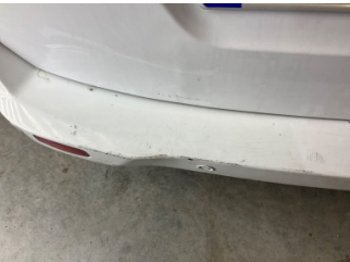
Tampon, arka, Arka tampon > Boyası Atmış
