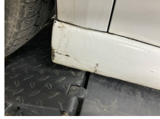
Marşbiyel, sol, Marşbiyel plastiği, sol > Çatlak
