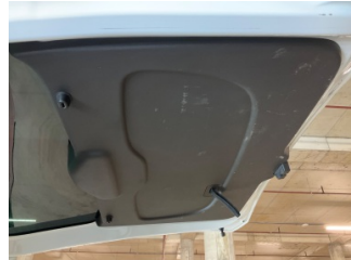
Döşemeler/Kapaklar, Bagaj kapağı, iç döşemesi > Çizik
