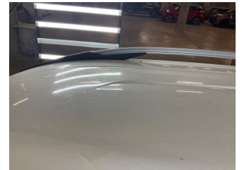
Tavan, Tavan > Dolu Hasarı
