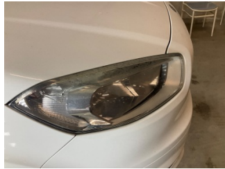
Farlar, Far camı, sağ > Deforme Olmuş
