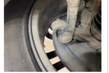
Direksiyon sistemi, Rot kolu/Rot başı, sol > Hasarlı
