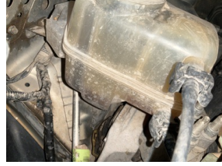
Motorsoğutması, Soğutma sıvısı > Eksik
