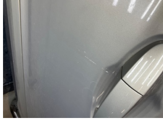
Kapı, sağ ön, Kapı, sağ ön > Çizik
