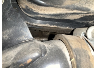
Motor, Motor > Yağ Kaçağı
