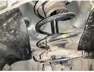
Ön aks, Amortisör körüğü, sağ > Hasarlı
