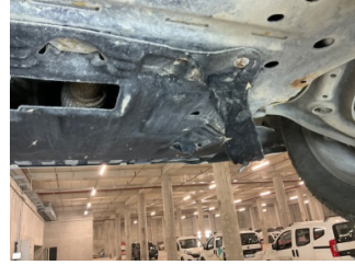
Motor, Alt muhafaza > Hasarlı
