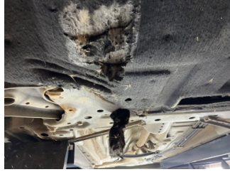
Motor, Alt muhafaza > Hasarlı
