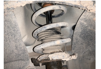
Ön aks, Amortisör körüğü, sol > Hasarlı
