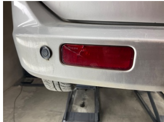
Tampon, arka, Reflektör, sol > Çatlak
