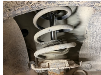
Ön aks, Amortisör körüğü, sağ > Hasarlı
