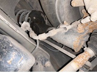
Ön aks, Amortisör, ön sol > Yağ Kaçağı
