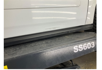
Marşbiyel, sağ, Marşbiyel plastığı, sağ > Çizik
