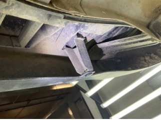
Tampon, arka, Bağlantı ayağı > Kırılmış
