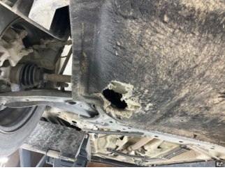
Motor, Alt muhafaza > Hasarlı
