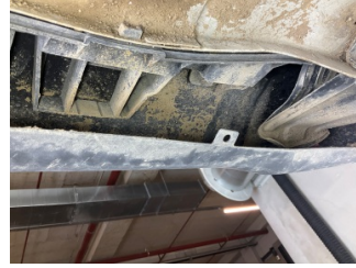
Tampon, arka, Bağlantı ayağı > Hasarlı
