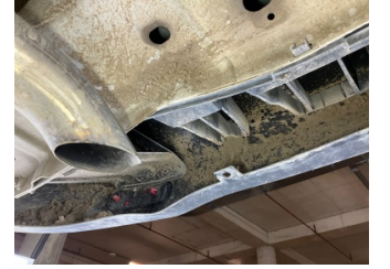
Tampon, arka, Bağlantı ayağı > Hasarlı
