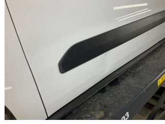
Kapı, sol ön, Kapı, sol ön > Ezik
