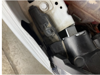
Farlar, Far bağlantı ayağı, sağ > Hasarlı
