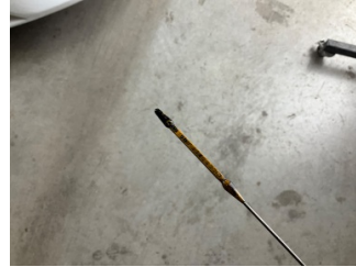
Motor, Yağ seviyesi > Eksik
