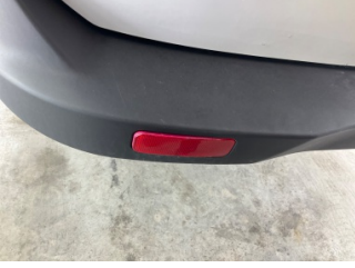
Tampon, arka, Reflektör, sol > Sabitlemesi Hatalı
