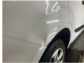
Çamurluk, sağ arka, Çamurluk, sağ arka > Ezik
