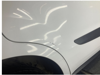
Kapı, sağ arka, Kapı, sağ arka > Ezik
