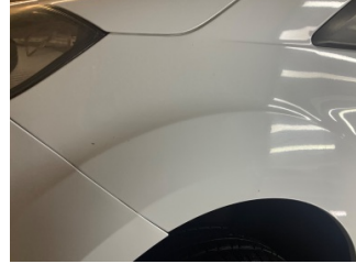
Çamurluk, sol, Çamurluk, sol > Taş Izi
