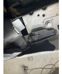
Farlar, Far bağlantı ayağı, sol > Hasarlı
