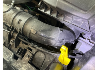
Motor, Hava filtresi kabı > Standart Dışı Onarım
