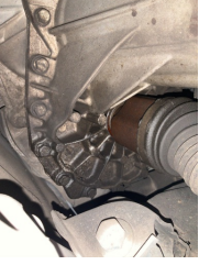
Şanzıman, Şanzıman > Yağ Kaçağı
