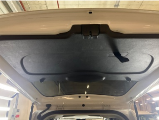
Döşemeler/Kapaklar, Bagaj kapağı, iç döşemesi > Çizik
