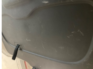
Döşemeler/Kapaklar, Bagaj kapağı, iç döşemesi > Çizik
