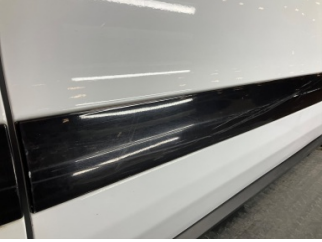
Kapı, sağ ön, Kapı bandı > Çizik
