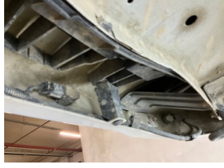
Tampon, arka, Bağlantı ayağı > Hasarlı
