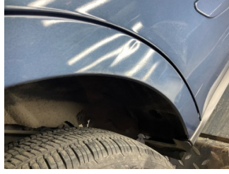
Çamurluk, sağ arka, Çamurluk, sağ arka > Ezik
