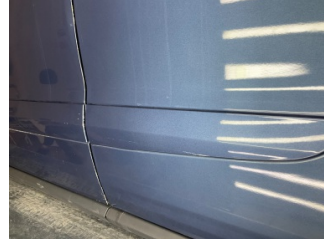
Kapı, sol arka, Kapı bandı > Çizik
