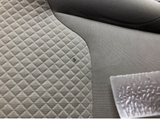
Döşemeler/Kapaklar, Döşemeler/Kapaklar > Yakıcı Madde Ile Zarar Görmüş
