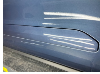
Kapı, sağ ön, Kapı bandı > Çizik
