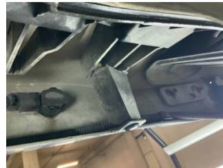
Tampon, arka, Bağlantı ayağı > Hasarlı
