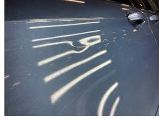
Kapı, sağ arka, Kapı, sağ arka > Ezik
