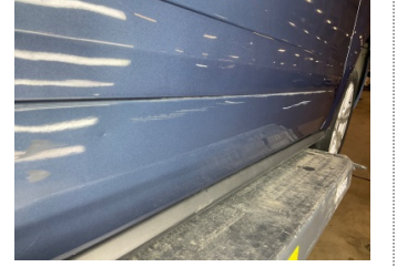
Kapı, sağ ön, Kapı, sağ ön > Çizik
