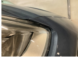
Tampon, ön, Ön tampon > Sabitlemesi Hatalı
