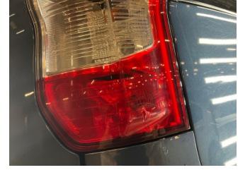
Arka lambalar, Arka lamba camı, sağ > Hasarlı
