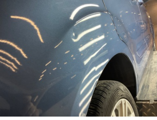
Çamurluk, sağ arka, Çamurluk, sağ arka > Ezik
