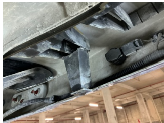
Tampon, arka, Bağlantı ayağı > Hasarlı
