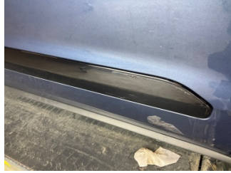
Kapı, sağ ön, Kapı bandı > Çizik
