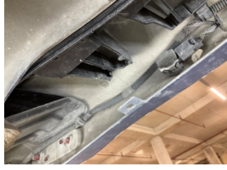
Tampon, arka, Bağlantı ayağı > Hasarlı
