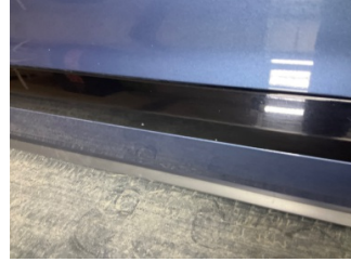
Kapı, sol ön, Kapı bandı > Çizik
