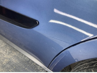
Kapı, sol arka, Kapı, sol arka > Çizik
