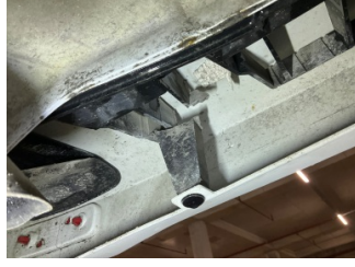
Tampon, arka, Bağlantı ayağı > Kırılmış
