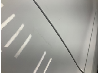
Kapı, sol ön, Kapı, sol ön > Ezik
