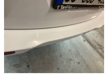
Tampon, arka, Arka tampon > Çatlak
