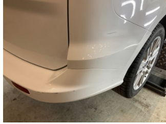
Tampon, arka, Arka tampon > Çatlak
