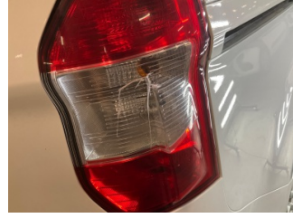
Arka lambalar, Arka lamba camı, sağ > Çatlak
