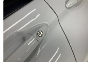
Kapı, sol ön, Kapı, sol ön > Ezik
