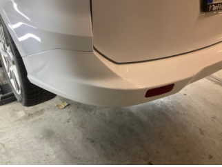
Tampon, arka, Arka tampon > Çatlak
