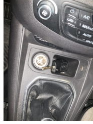
Elektrik donanımı/Pano, Çakmak > Sökülmüş-Yok
