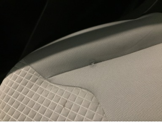
Döşemeler/Kapaklar, Döşemeler/Kapaklar > Yakıcı Madde Ile Zarar Görmüş
