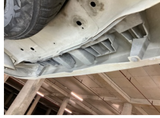
Tampon, arka, Bağlantı ayağı > Hasarlı
