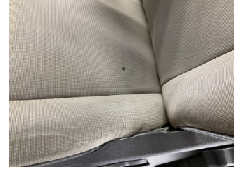
Döşemeler/Kapaklar, Döşemeler/Kapaklar > Yakıcı Madde Ile Zarar Görmüş
