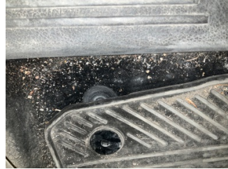
Döşemeler/Kapaklar, Döşemeler/Kapaklar > Yakıcı Madde Ile Zarar Görmüş
