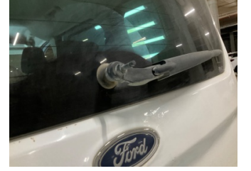
Cam yıkama/silme sistemi, Silecek mekanizması > Eksik
