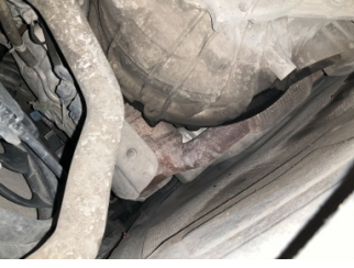
Şanzıman, Şanzıman > Yağ Kaçağı
