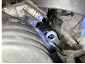
Motor, Motor > Yağ Kaçağı
