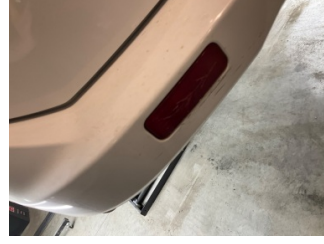
Tampon, arka, Reflektör, sağ > Hasarlı
