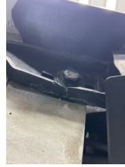
Farlar, Far bağlantı ayağı, sol > Hasarlı
