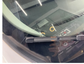
Camlar, Ön cam > Çatlak
