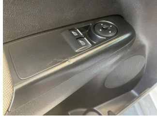
Döşemeler/Kapaklar, Döşemeler/Kapaklar > Çizik
