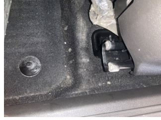
Döşemeler/Kapaklar, Döşemeler/Kapaklar > Yakıcı Madde Ile Zarar Görmüş
