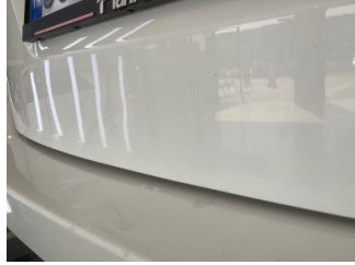
Bagaj kapağı/kapısı, Bagaj kapısı > Noktasal Ezik
