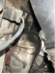
Motor, Külbütör kapağı > Yağ Kaçağı
