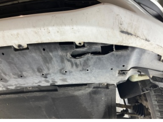
Tampon, ön, Tampon koruyucu orta > Hasarlı
