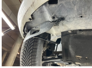
Tampon, ön, Tampon koruyucu orta > Hasarlı
