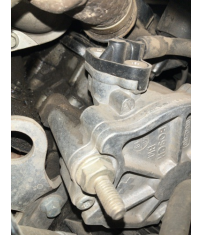
Motor, Külbütör kapağı > Yağ Kaçağı
