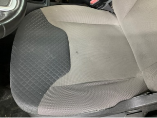
Döşemeler/Kapaklar, Döşemeler/Kapaklar > Yakıcı Madde İle Zarar Görmüş
