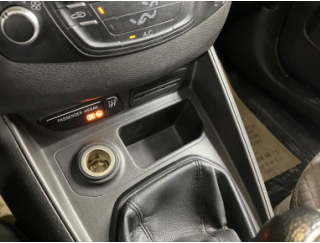
Elektrik donanımı/Pano, Çakmak > Sökülmüş-Yok
