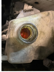
Motorsoğutması, Soğutma sıvısı > Kirlenmiş
