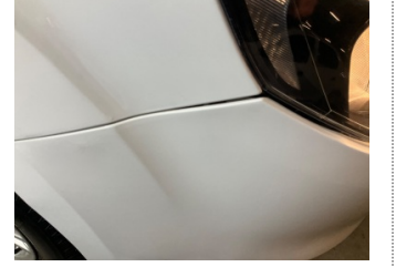
Tampon, ön, Ön tampon > Sabitlemesi Hatalı
