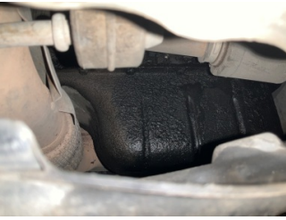
Motor, Motor > Yağ Kaçağı
