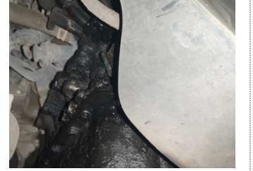
Motor, Motor > Yağ Kaçağı
