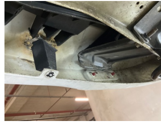
Tampon, arka, Bağlantı ayağı > Hasarlı
