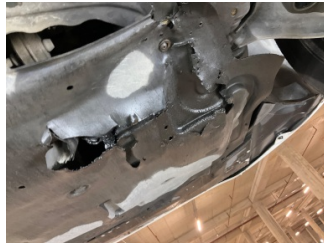
Motor, Alt muhafaza > Hasarlı
