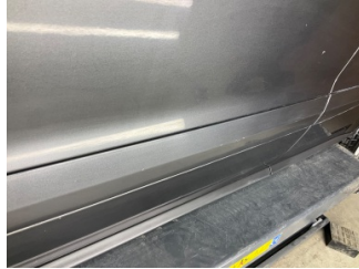
Kapı, sol ön, Kapı bandı > Çizik
