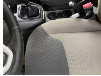
Döşemeler/Kapaklar, Döşemeler/Kapaklar > Yakıcı Madde ile Zarar Görmüş
