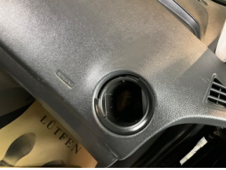
Kalorifer/Klima, Havalandırma ızgarası > Hasarlı
