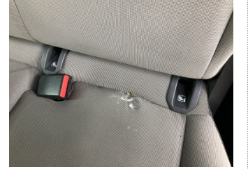
Döşemeler/Kapaklar, Döşemeler/Kapaklar > Yakıcı Madde ile Zarar Görmüş
