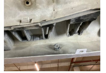
Tampon, arka, Bağlantı ayağı > Hasarlı
