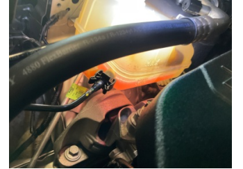
Motorsoğutması, Soğutma sıvısı > Eksik
