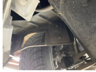
Tampon, ön, Tampon koruyucu orta > Sökülmüş-Yok
