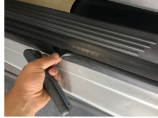
Döşemeler/Kapaklar, Döşemeler/Kapaklar > Yakıcı Madde ile Zarar Görmüş
