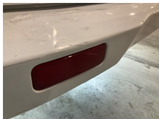
Tampon, arka, Reflektör, sol > Çatlak
