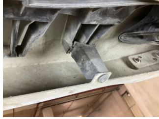
Tampon, arka, Bağlantı ayağı > Hasarlı
