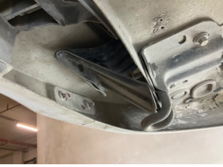
Tampon, arka, Bağlantı ayağı > Hasarlı
