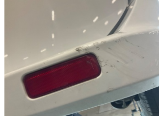
Tampon, arka, Reflektör, sağ > Çatlak
