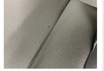
Döşemeler/Kapaklar, Döşemeler/Kapaklar > Yakıcı Madde Ile Zarar Görmüş
