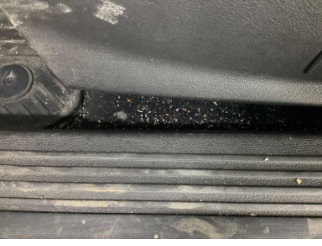
Döşemeler/Kapaklar, Döşemeler/Kapaklar > Yakıcı Madde Ile Zarar Görmüş
