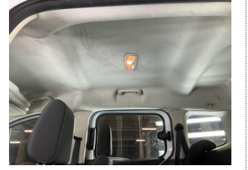
Döşemeler/Kapaklar, Döşemeler/Kapaklar > Deforme Olmuş
