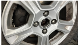
Jant göbeği kapağı, ön sol > Sökülmüş-Yok
