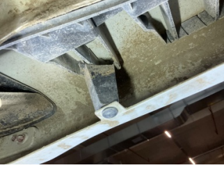
Tampon, arka, Bağlantı ayağı > Kırılmış
