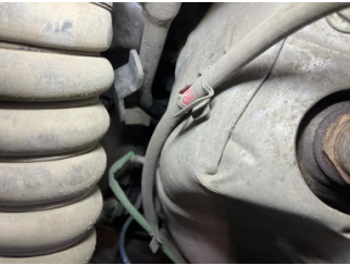
Motor, Yağ kontrol cubuğu > Sabitlemesi Hatalı
