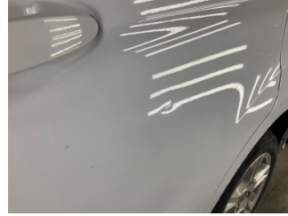
Kapı, sol arka, Kapı, sol arka > Çizik
