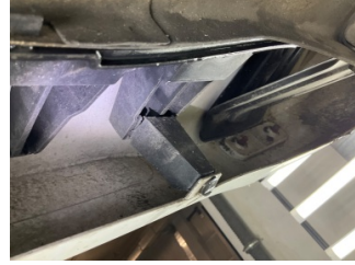
Tampon, arka, Bağlantı ayağı > Kırılmış
