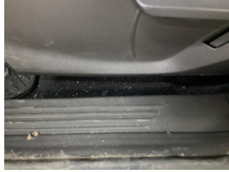
Döşemeler/Kapaklar, Döşemeler/Kapaklar > Yakıcı Madde Ile Zarar Görmüş
