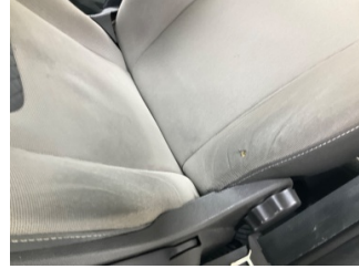
Döşemeler/Kapaklar, Döşemeler/Kapaklar > Yakıcı Madde Ile Zarar Görmüş
