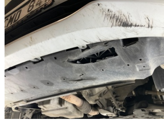
Tampon, ön, Tampon koruyucu orta > Hasarlı
