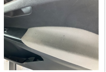
Döşemeler/Kapaklar, Döşemeler/Kapaklar > Yakıcı Madde Ile Zarar Görmüş
