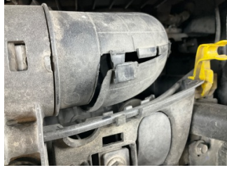
Motor, Hava filtresi kabı > Kırılmış
