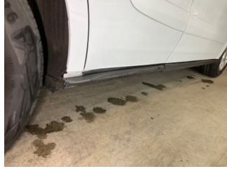
Marşbiyel, sağ, Marşbiyel plastığı, sağ > Sabitlemesi Hatalı
