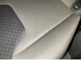
Döşemeler/Kapaklar, Döşemeler/Kapaklar > Yakıcı Madde İle Zarar Görmüş
