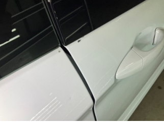
Kapı, sağ ön, Kapı, sağ ön > Boyası Atmış
