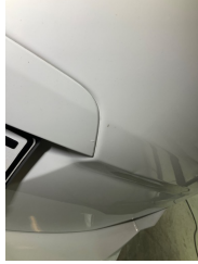
Bagaj kapağı/kapısı, Bagaj kapısı > Vuruk
