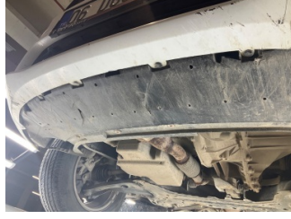
Tampon, ön, Tampon koruyucu orta > Hasarlı
