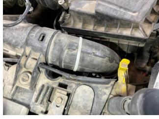
Motor, Hava filtresi kabı > Standart Dışı Onarım
