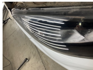
Farlar, Far camı, sağ > Deforme Olmuş
