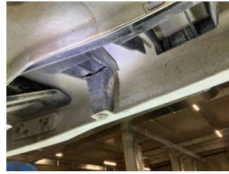
Tampon, arka, Bağlantı ayağı > Kırılmış
