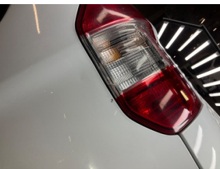
Arka lambalar, Arka lamba camı, sağ > Çatlak
