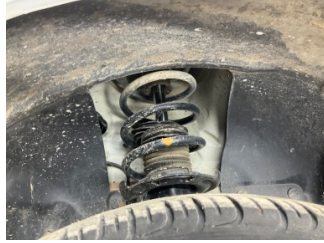
Ön aks, Amortisör körüğü, sağ > Hasarlı
