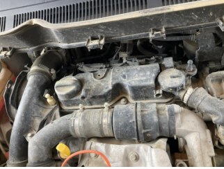
Motor, Motor üst kapağı, plastik > Sökülmüş-Yok
