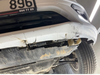
Tampon, ön, Tampon koruyucu orta > Hasarlı
