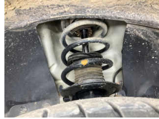
Ön aks, Amortisör körüğü, sol > Hasarlı
