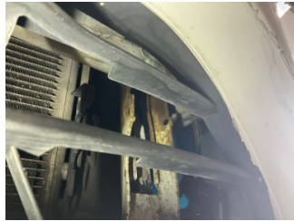
Tampon, ön, Bağlantı ayağı > Ezik
