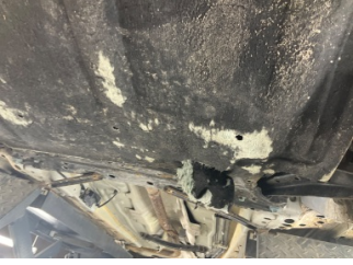
Motor, Alt muhafaza > Hasarlı
