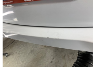
Tampon, arka, Arka tampon > Boyası Atmış
