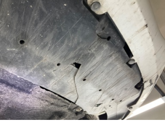
Tampon, ön, Tampon koruyucu orta > Hasarlı
