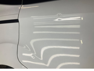
Kapı, sağ arka, Kapı, sağ arka > Ezik
