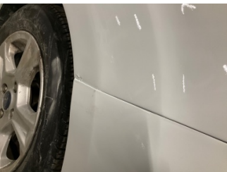
Çamurluk, sağ, Çamurluk, sağ > Vuruk
