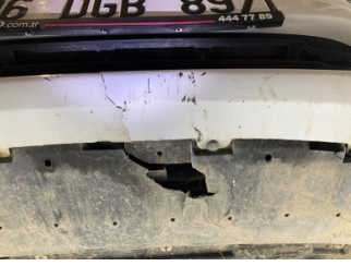
Tampon, ön, Tampon koruyucu orta > Hasarlı
