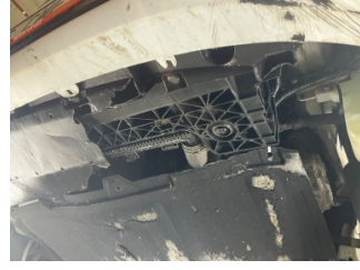
Tampon, ön, Tampon koruyucu orta > Hasarlı
