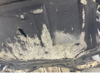
Motor, Alt muhafaza > Hasarlı
