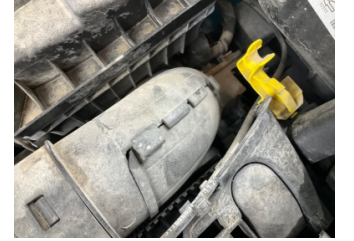
Motor, Hava filtresi kabı > Kırılmış
