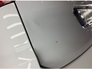
Bagaj kapağı/kapısı, Bagaj kapısı > Vuruk
