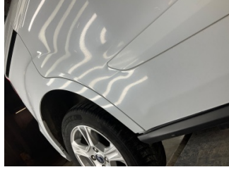
Kapı, sağ arka, Kapı, sağ arka > Ezik
