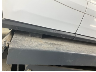
Marşbiyel, sağ, Marşbiyel plastığı, sağ > Çizik
