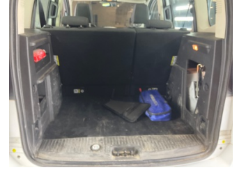
Döşemeler/Kapaklar, Pandizot > Sökülmüş-Yok
