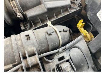
Motor, Hava filtresi kabı > Kırılmış
