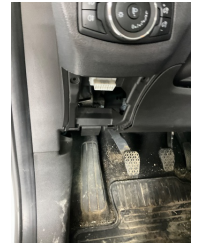
Pano/Göstergeler, Kapak > Sökülmüş-Yok
