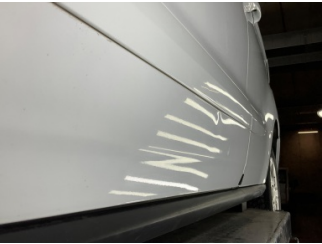
Kapı, sol ön, Kapı, sol ön > Ezik
